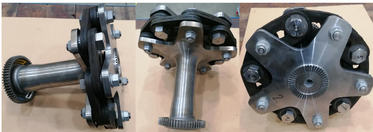
Obrázek 1 Prototyp výstupní spojky s pryžovými elementy – hybridní
