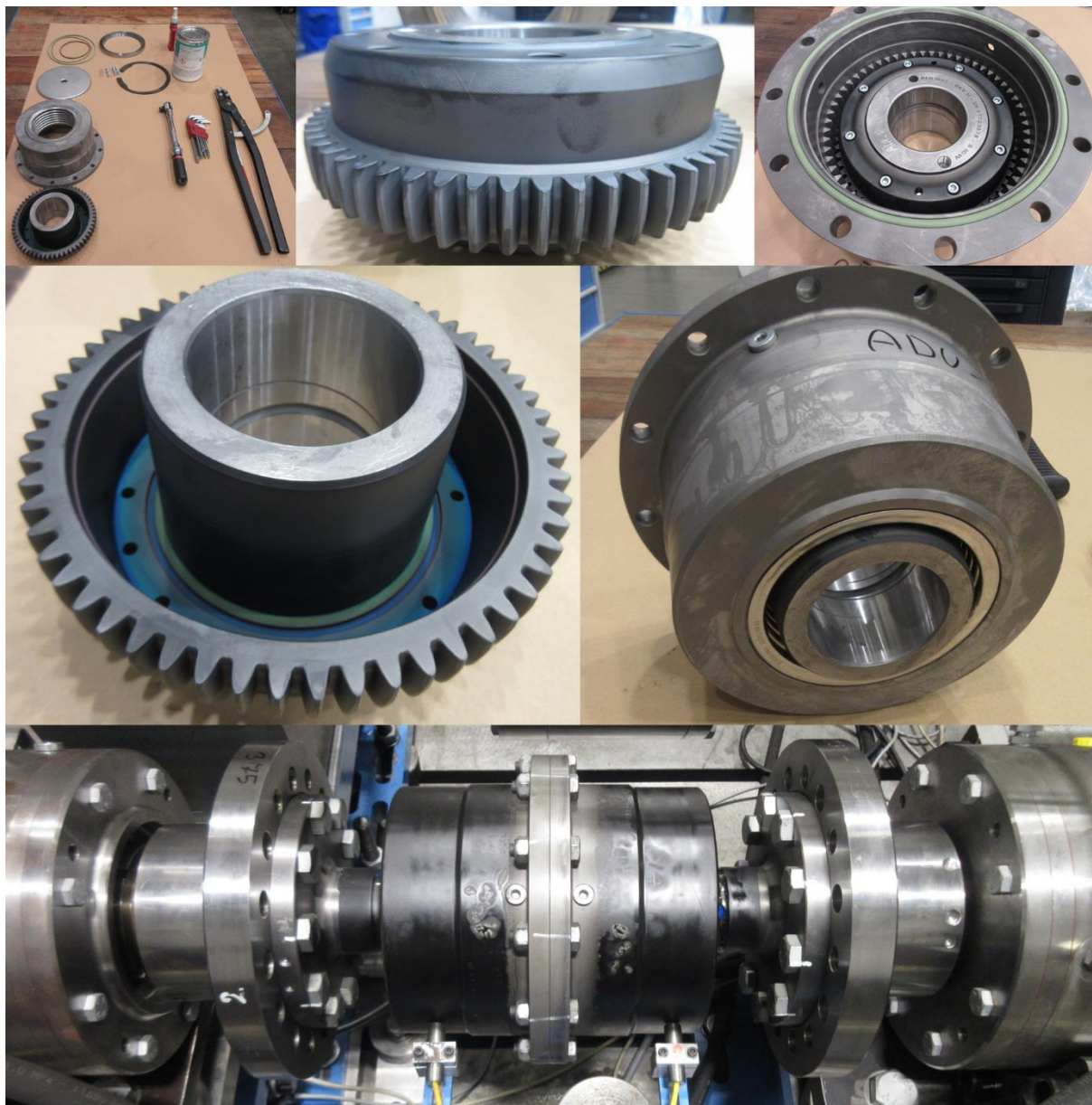
Obrázek 1 Funkční vzorek vstupní zubové spojky s nízkým součinitelem tření
