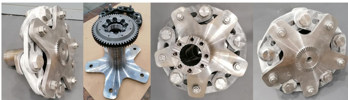
Obrázek 1 Funkční vzorek výstupní spojky s pryžovými elementy – hybridní
