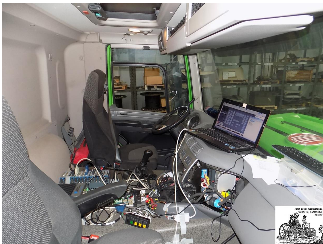
Obrázek 2 HIL testování prototypu vozidla s mechatronickým systémem TDM a testování s prototypem ECU
