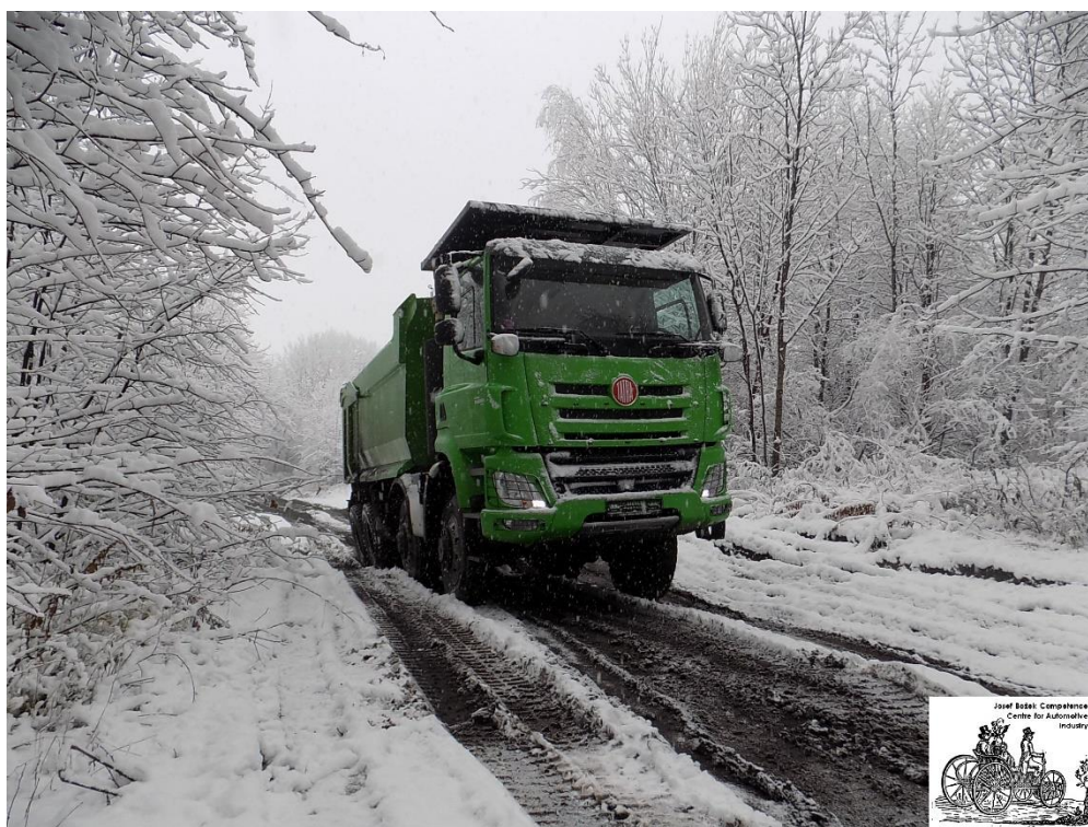
Obrázek 1 Prototyp vozidla T158 se systémem TDM při testech v těžkých adhezních podmínkách
