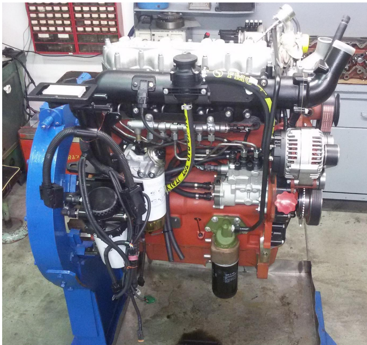
Obrázek 1 Funkční vzorek kabeláže s CAN komunikací – osazení na motoru P3
