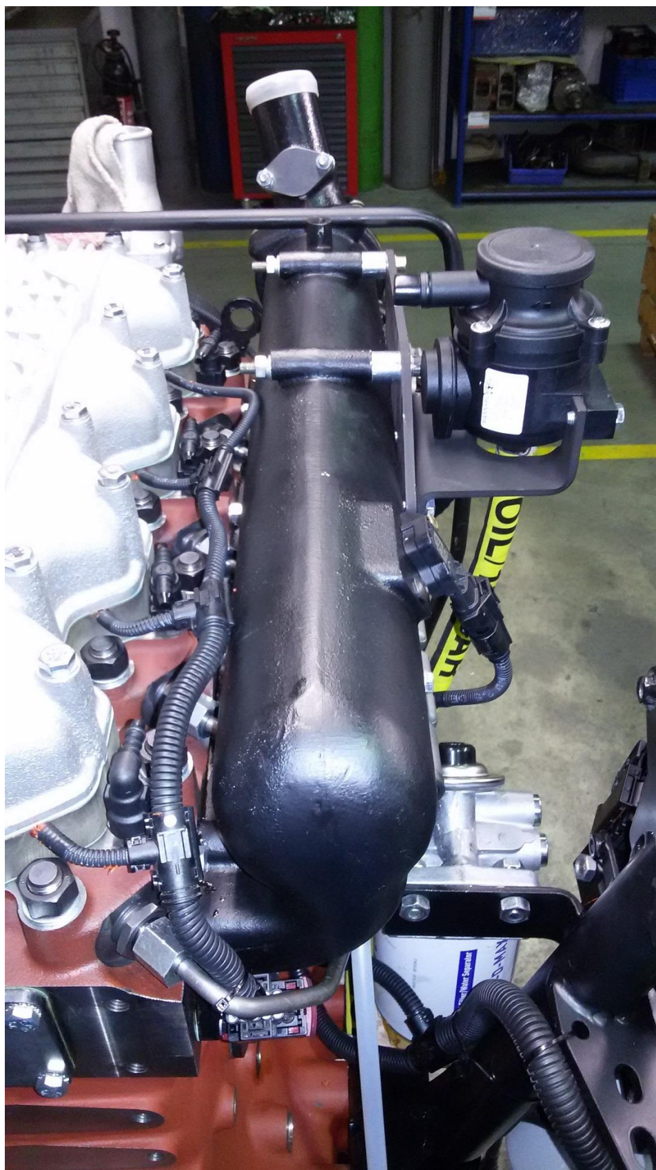
Obrázek 3 Detail vedení kabeláže u hlavy válců včetně napojení ke vstřikovačům
