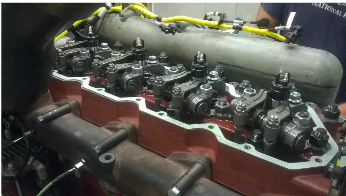
Obrázek 1 Funkční vzorek motoru P2 se vstřikovacím systémem typu common rail – detail hlavy válců osazené elektronicky řízenými vstřikovači
