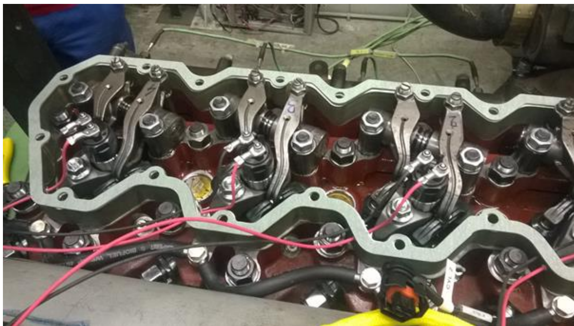
Obrázek 1 Funkční vzorek vstříkovacího systému s optimalizovanou tryskou instalovaný do hlavy motoru
