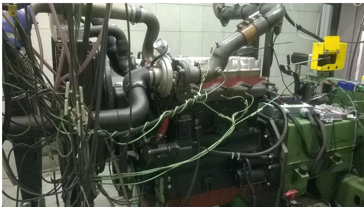
Obrázek 2 Funkční vzorek motoru P1 na motorové zkušebně s instalovaným funkčním vzorkem vstříkovacího systému s optimalizovanou tryskou
