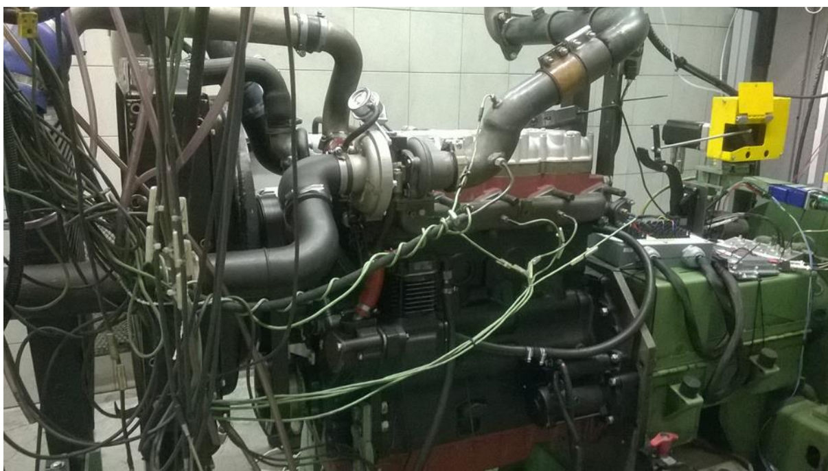
Obrázek 3 Funkční vzorek motoru na motorové zkušebně
