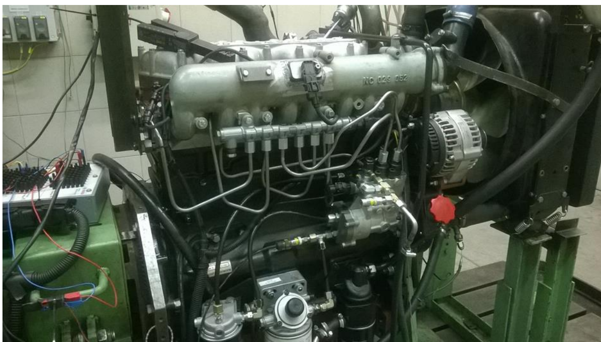
Obrázek 1 Funkční vzorek motoru se vstřikovacím systémem typu common rail
