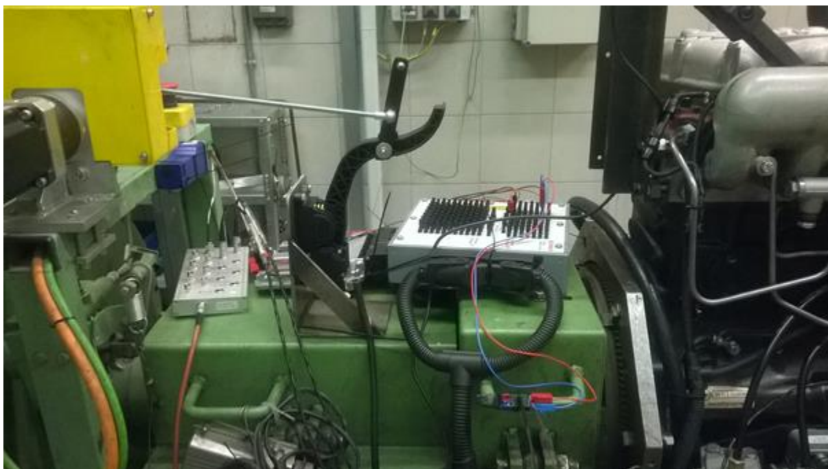
Obrázek 2 Funkční vzorek motoru včetně přípravku pro elektronické řízení
