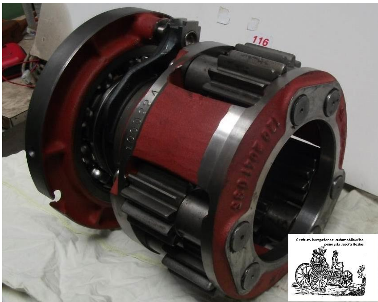
Obrázek 3 Pohled ze strany vstupu osového diferenciálu k zadním nápravám
