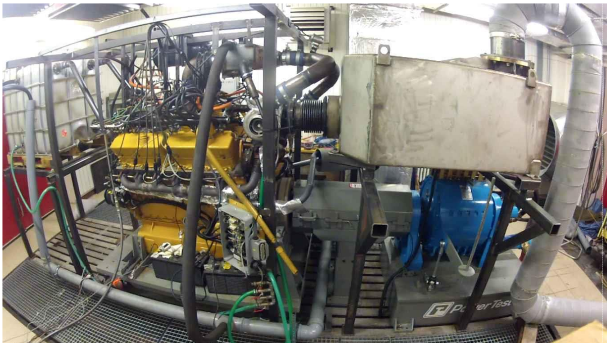
Obrázek 1 Celkový pohled motor s instalovanou jednotkou pro chlazení nasávaného vzduchu na zkušebně spalovacích motorů ÚADI
