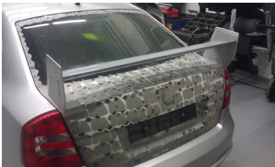
Obrázek 3 Zadní nastavitelný aerodynamický prvek experimentálního vozidla
