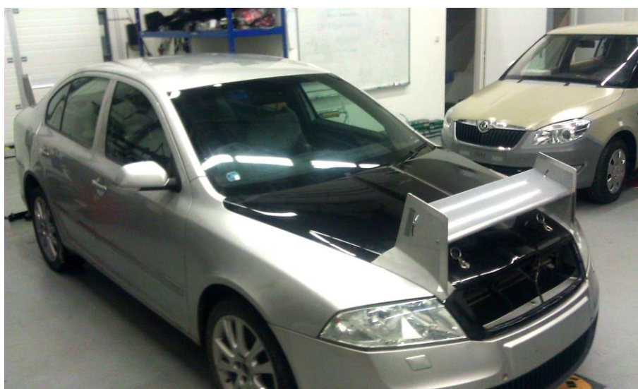
Obrázek 1 Experimentální vozidlo pro měření aerodynamické stability
