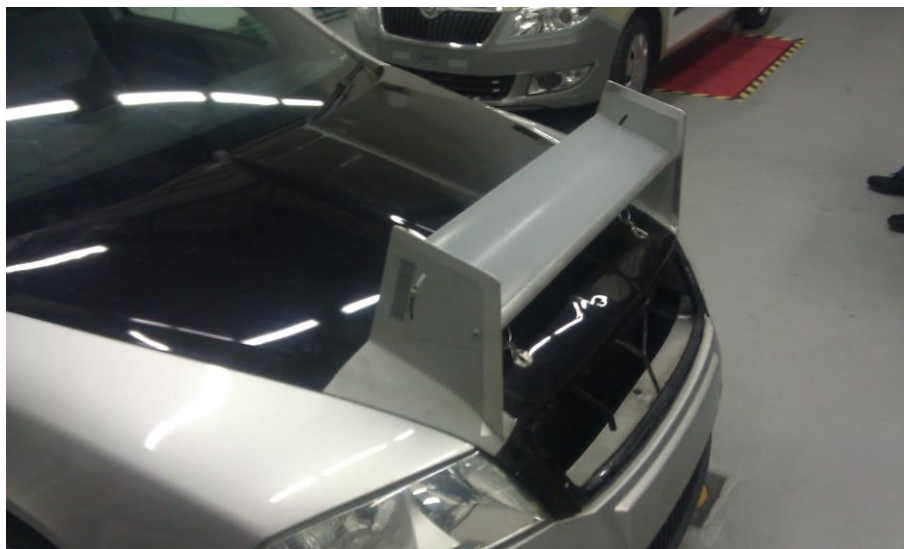
Obrázek 2 Přední nastavitelný aerodynamický prvek experimentálního vozidla
