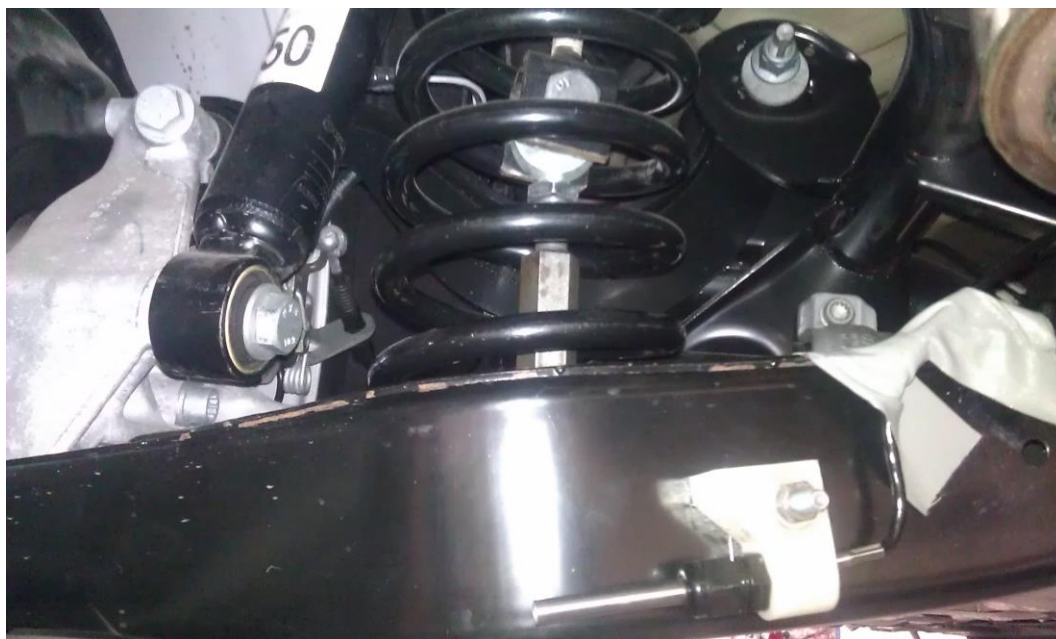
Obrázek 2 Přípravek pro fixaci polohy karoserie na zadní nápravě
