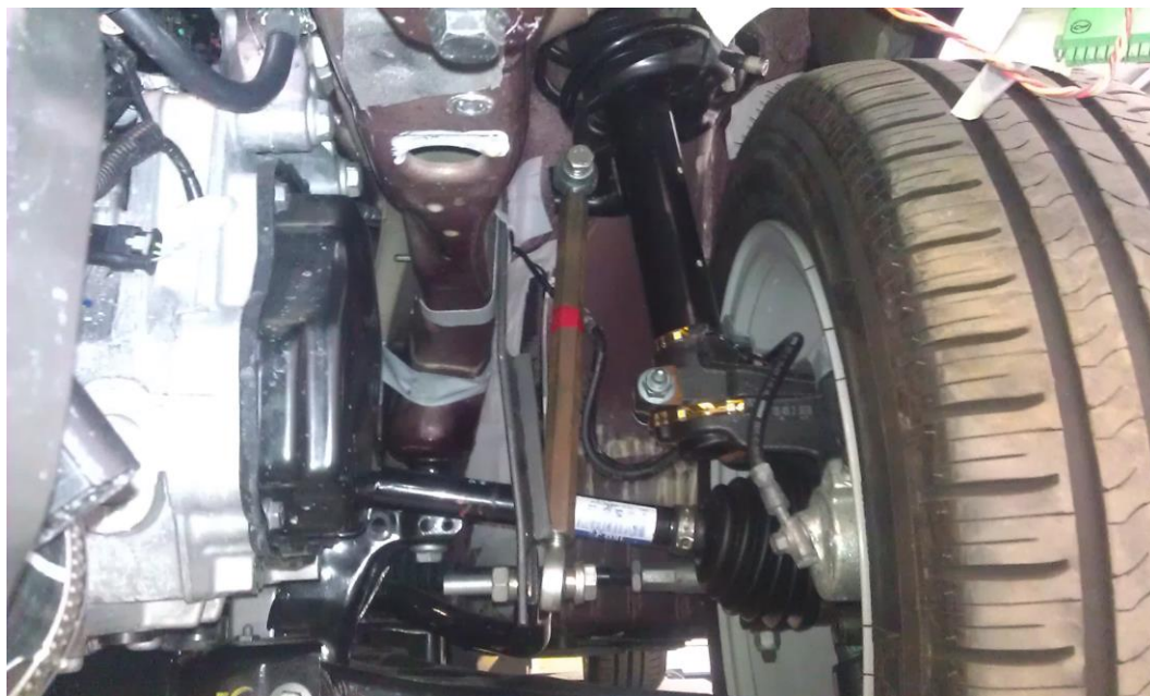
Obrázek 1 Přípravek pro fixaci polohy karoserie na přední nápravě
