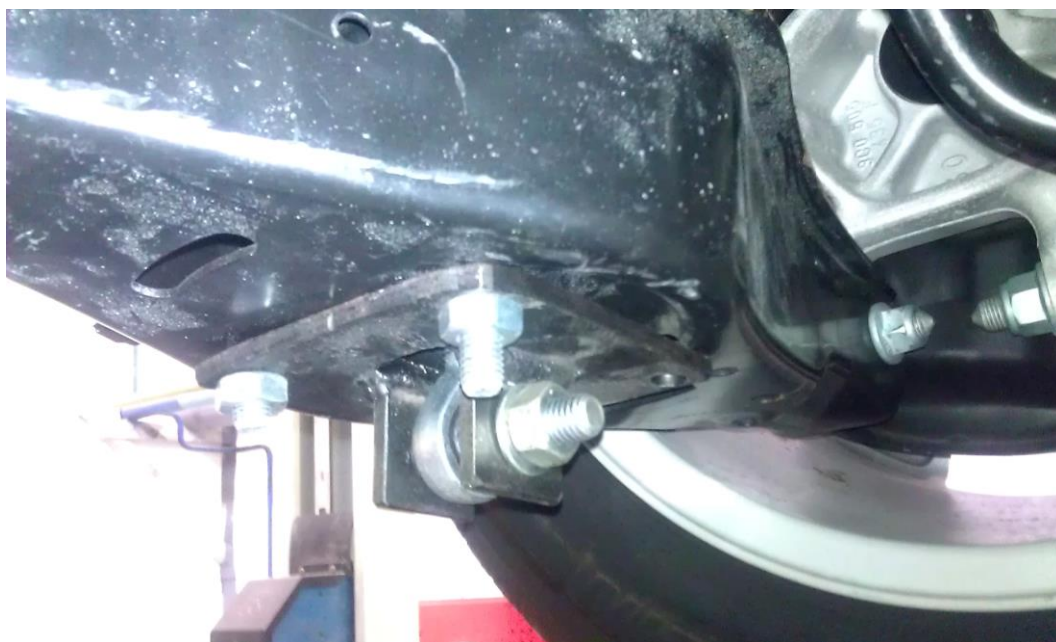
Obrázek 3 Přípravek pro fixaci polohy karoserie na zadní nápravě
