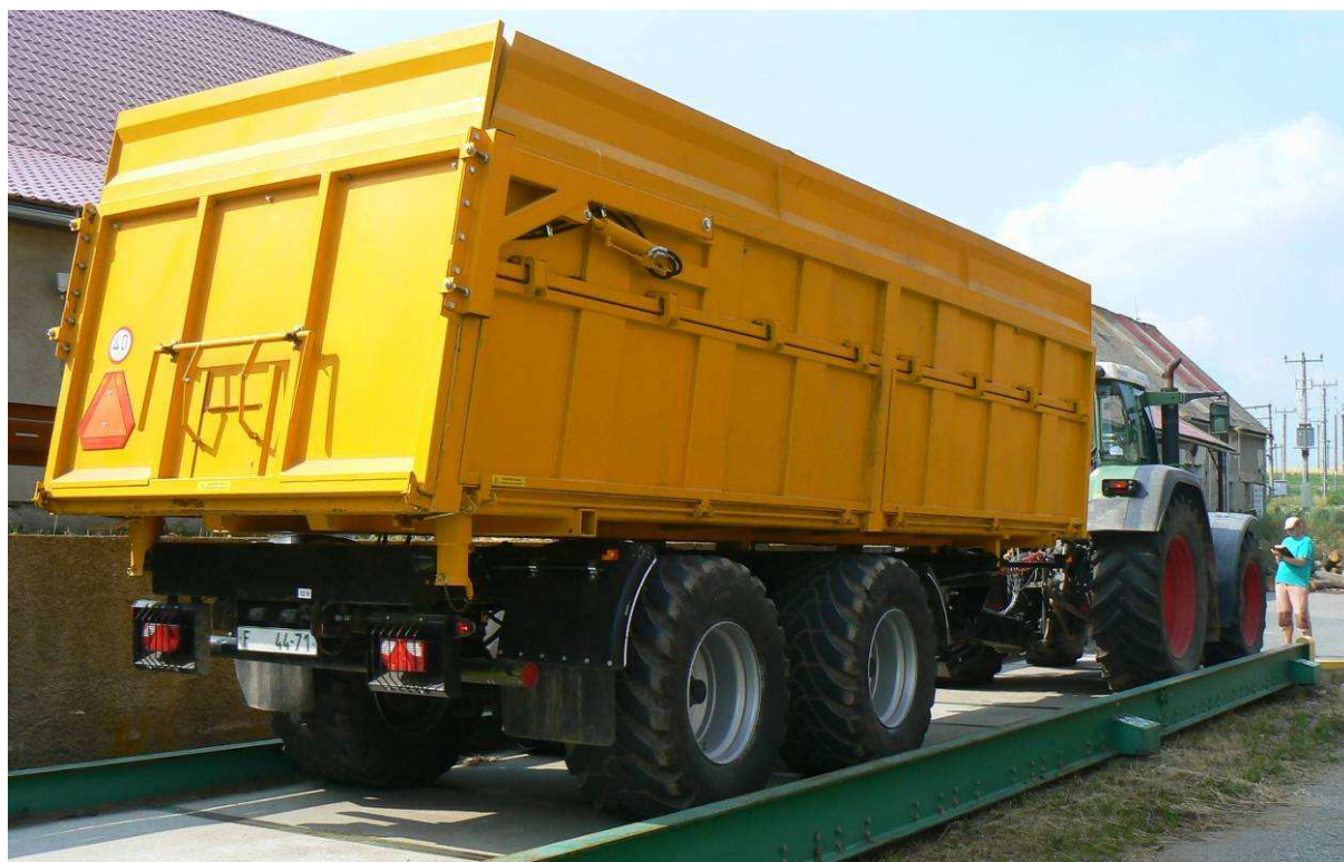
Obrázek 1 Traktorový návěs s výměnnou korbovou nástavbou pro zemědělské produkty.
