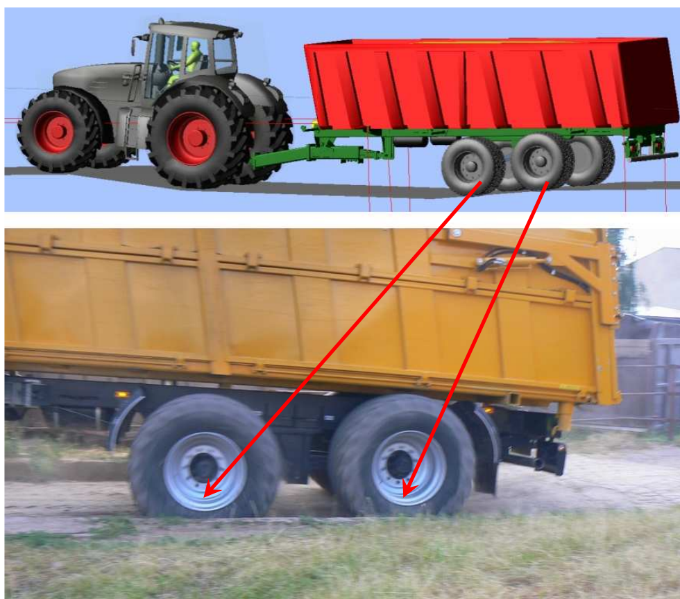
Obrázek 5 Počítačová simulace dynamiky pohybu návěsu v MBS systému ADAMS 2005 v porovnání se skutečným průběhem při měření.
