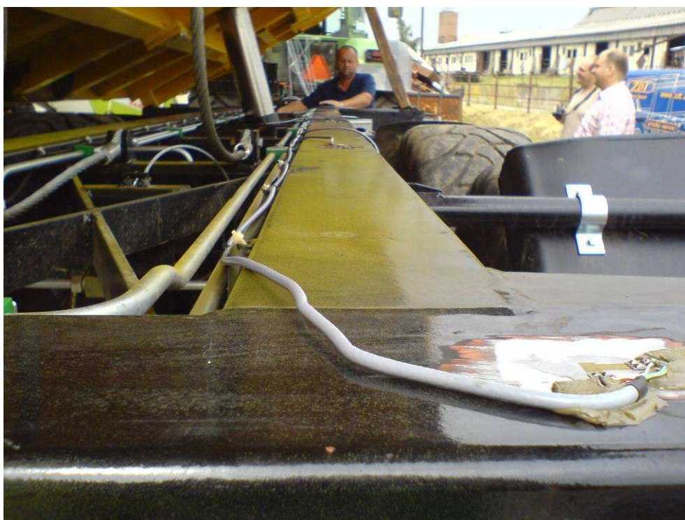
Obrázek 4 Aplikace tenzometrů na rám traktorového návěsu
