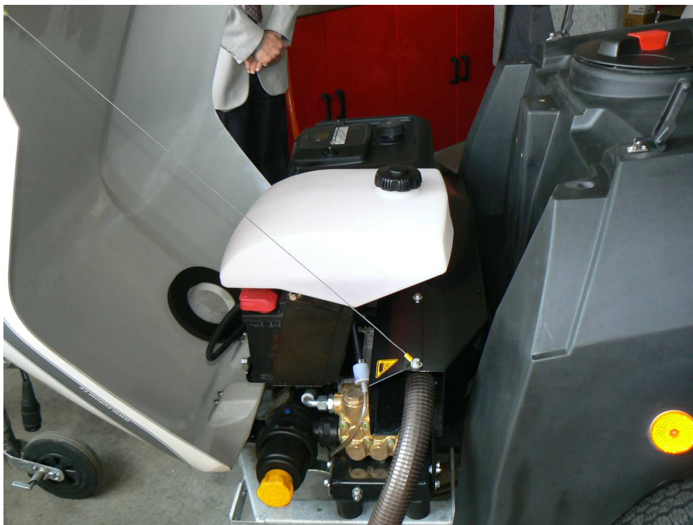
Obrázek 7 Foto prototypu sprchového čističe pro kontaminované úkapy – pohled na nádobku s čisticí kapalinou uložené v motorovém prostoru stroje.
