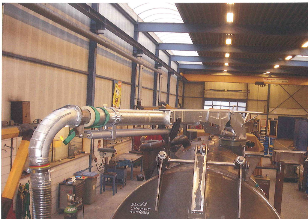
Obrázek 4 Zkouška cisterny s ramenem při kompletaci stroje
