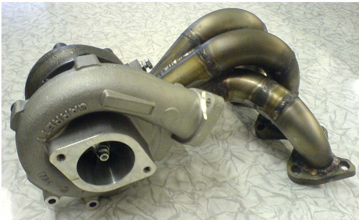
Obrázek 2 Sestava výfukového potrubí s turbodmychadlem
