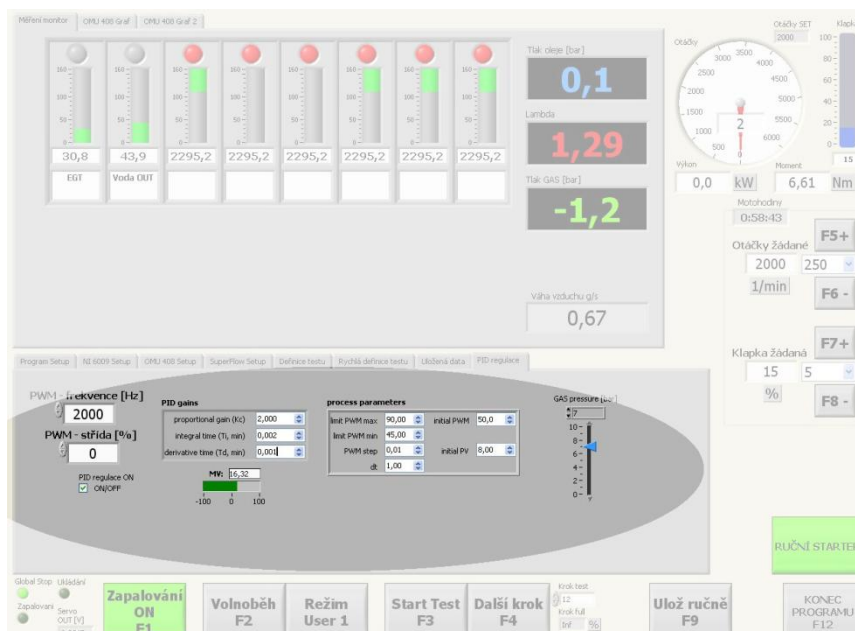
Obrázek 2 Ovládání CNG regulátoru jako součást ovládání motorové zkušebny
