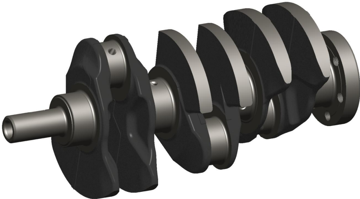
Obr. 1 Celkový náhled klikového hřídele nestandardního tříválcového motoru
