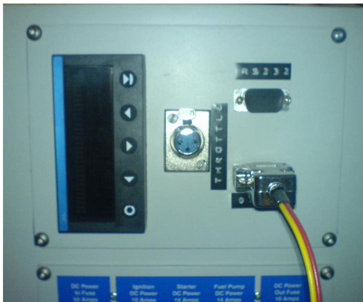
Obrázek 2 Pohled na instalovaný řídicí blok Univerzálního ovládání 8Nm (na panelu je patrný digitální a analogový vstup)
