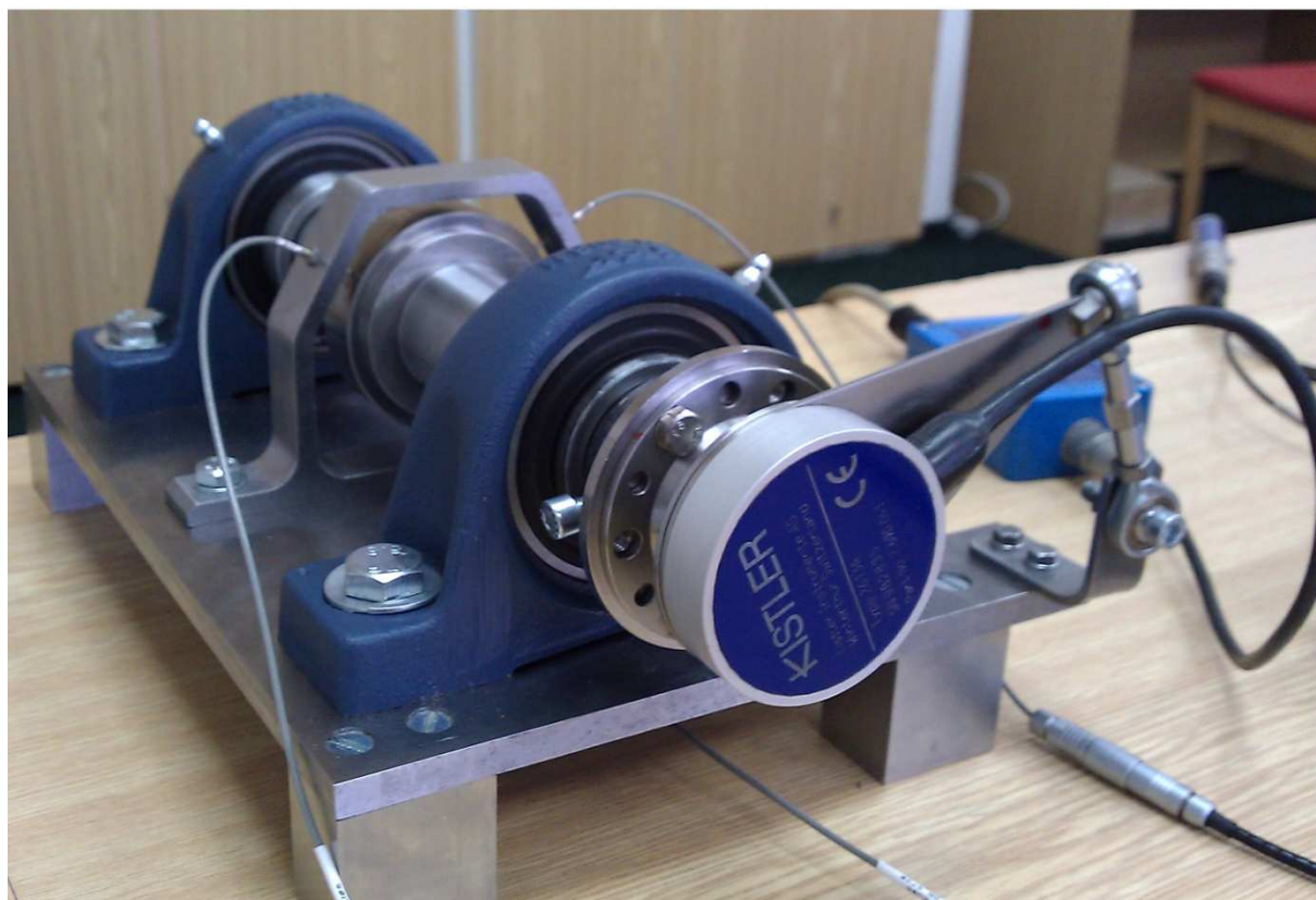
Obr. 3 Zadní konec s přírubou a specifickým senzorem, použitým i pro snímání otáček a polohy klikového hřídele spalovacího motoru
